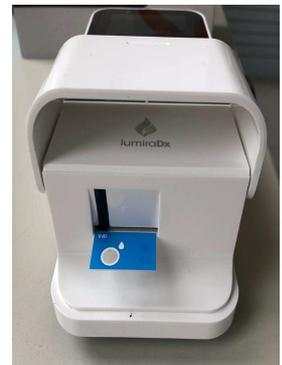
8. Non appena il LumiraDx® è pronto per la misurazione, mescolare il campione ancora una volta effettuando 2 o 3 rotazioni manuali prima del dosaggio.
