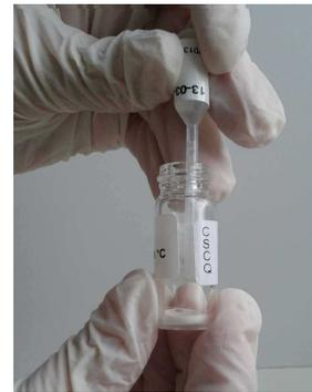
6. Mescolare delicatamente il contenuto del flacone effettuando un movimento rotatorio manuale fino a completo scioglimento del liofilizzato.
