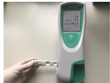
Dès le signal sonore, prélever exactement 150 µL d'échantillon à l'aide de la pipette (assurez-vous que l'échantillon ne présente aucune bulle d'air).
