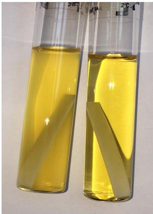
Bebrütete Teststreifen in einer Nährbouillon – Typ Trypcase Soja
